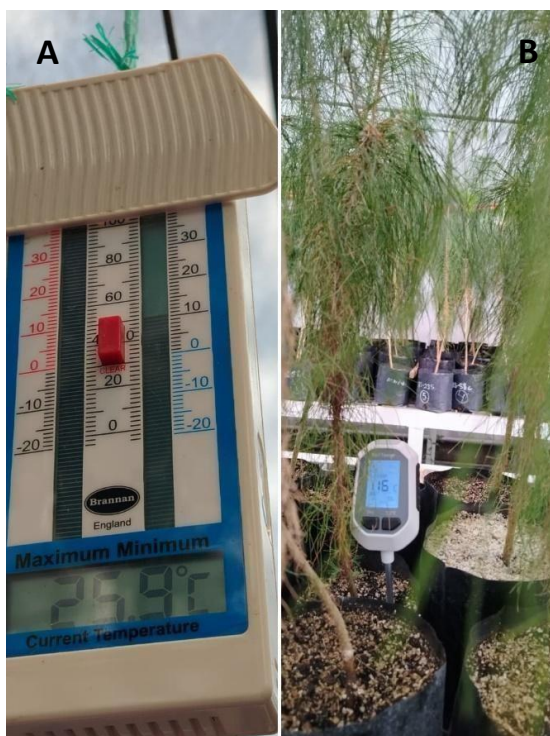
Figura 2. Equipos utilizados para el registro de temperatura y humedad en plantas de P.patula . A). Termómetro de mínimas y máximas; B). Sensor digital.
