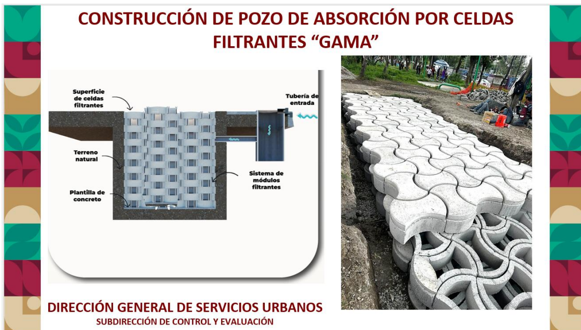
Figura 15. Presentación de construcción de pozo de absorción de SISTEMA PAICRET. Fuente: Elaboración propia, perteneciente a Subdirección de control y evaluación, Alcaldía Iztapalapa, Dirección General de Servicios Urbanos, 2025.
