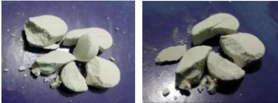
Figura 48. Tabletatas con problemas durante la compresión.
