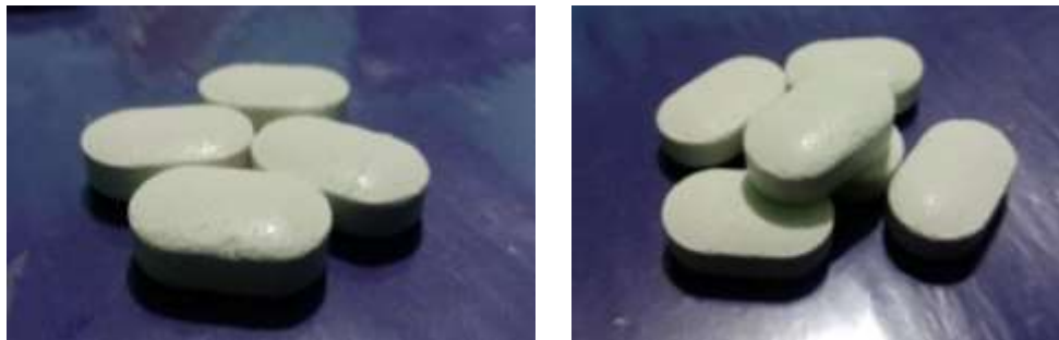
Figura 49. Tabletatas sin presencia de problemas de compresión
