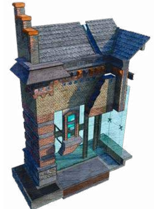
Imagen #71. Isométrico ilustrado - Exterior - Consolidación fachada Sur. Producción personal - MRPE.
