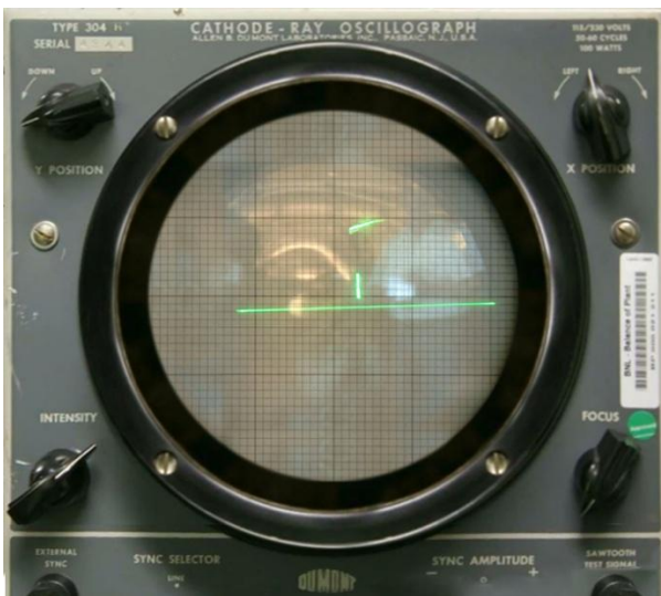
Figura 2. Tennis for Two , videojuego experimental diseñado por William Higinbotham en 1958, mostrado en un osciloscopio.
