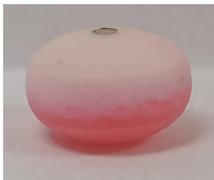
Figura 31 Comprimido osmótico correspondiente a la F1 con POLYOX WSR N80 al 35%, posterior al análisis en disolutor Hanson Research
