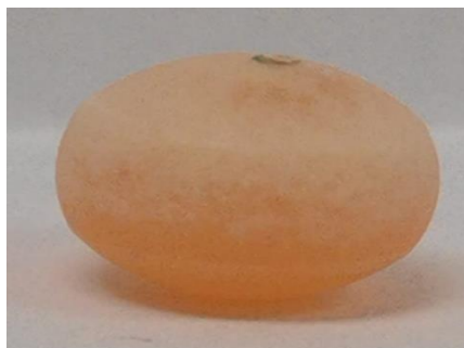
Figura 30 Comprimido osmótico correspondiente a la F4 con POLYOX WSR N80 al 70%, posterior al análisis en disolutor Hanson Research
