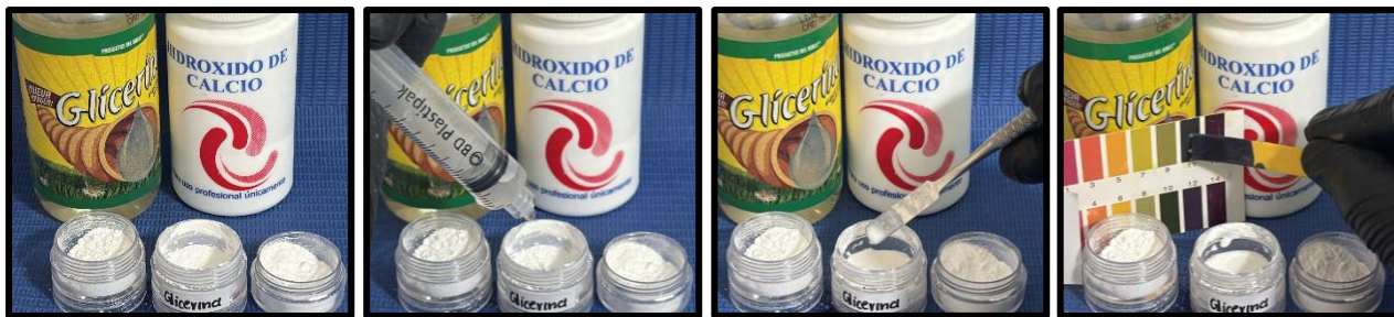
Ilustración 5. Proceso de mezclado del \text{Ca}(\text{OH})_2 con glicerina y obtención de la primera medida de pH.
