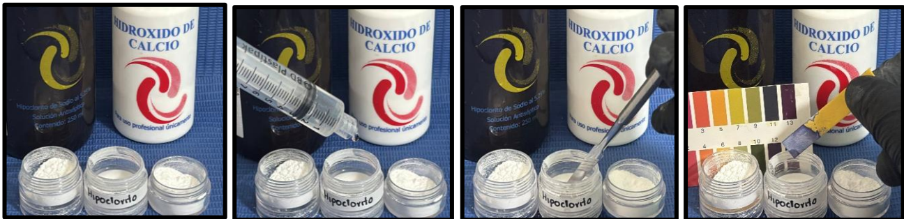
Ilustración 3. Proceso de mezclado del \text{Ca}(\text{OH})_2 con la solución de hipoclorito de sodio al 2.5% y obtención de la primera medida de pH.
