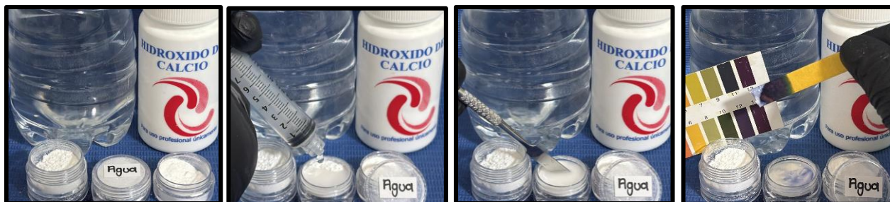
Ilustración 6. Proceso de mezclado del \text{Ca}(\text{OH})_2 con agua embotellada y obtención de la primera medida de pH.
