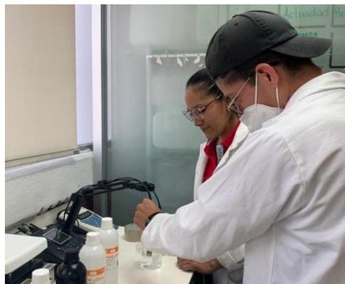
Figura 3. Verificación de pH y conductividad eléctrica en agua destilada
