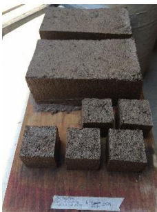
Fig.9. Adobes y cubos descimbrados
