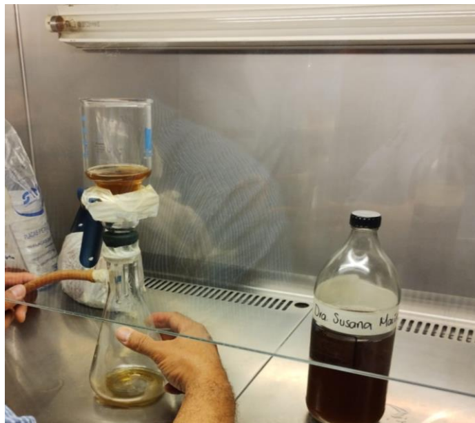
Figura 12. Esterilización de suero de caballo mediante sistema de filtración al vacío.
