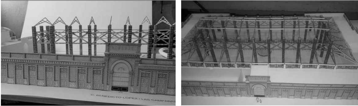
Fachada sur, mercado la Paz, Tlalpan, y detalles de la estructura de madera y columnas con bloques de piedra.
