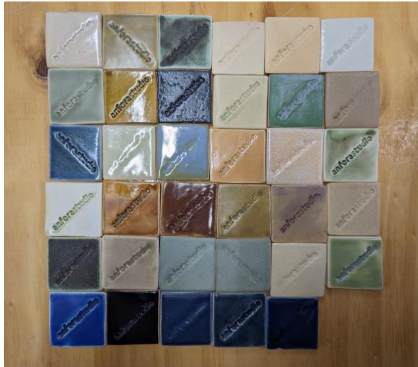
Foto 7. Placas después de la quema cono 9
