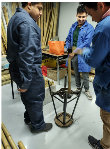
Imagen 5. Corte de bambú con ayuda de una cuchilla. Fotografía: Thelma Linares.
