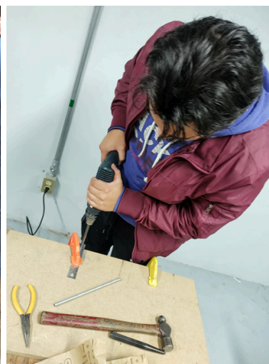
Imagen 6. Fabricación de los herrajes de sujeción para el ensamblado de la banca. Fotografía: Thelma Linares.
