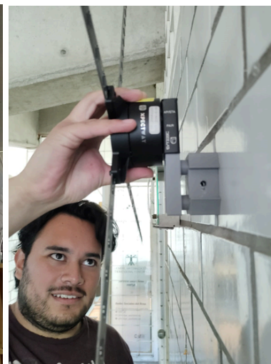
Imagen 16. Soporte de pared para el proyector holográfico, impreso en 3D. Fotografía: Saul Amauri López Román.
