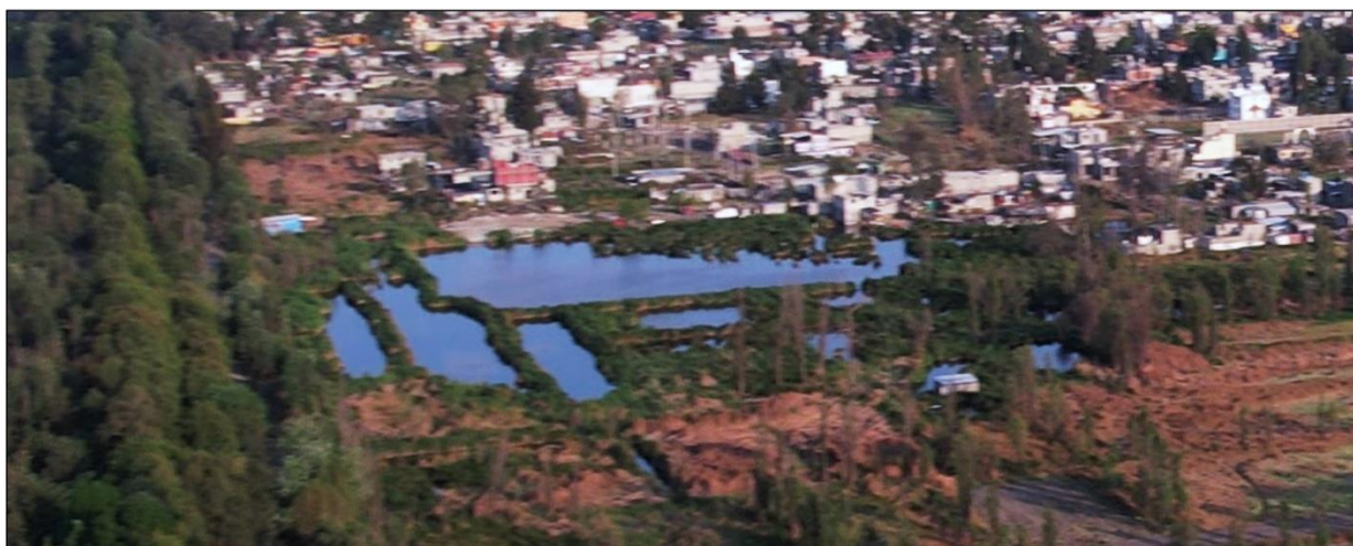
Fotografía 39. Identificación áreas anegadas al norte de la localidad. Esta circunstancia se debe a los hundimientos diferenciales presentes en la zona. El espejo de agua representa la forma de la chinampa pero hundida. Fuente: Propia, 2022.
