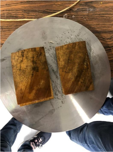
1 Resultado de prensado de hoja Caulinar como prueba de adhesión con lignina
