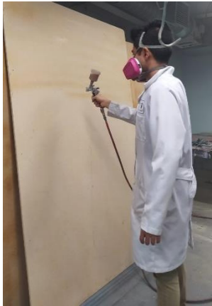
Figura 23.1 Sellado de mamparas en cabina de pintura para la exposición de la Feria del Libro y la ciudad.
