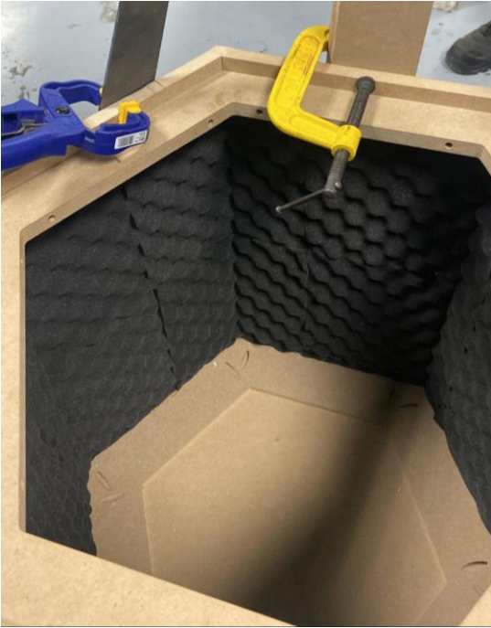
Forrado interno con espuma aislante de ruido para cámara de resonancia.
