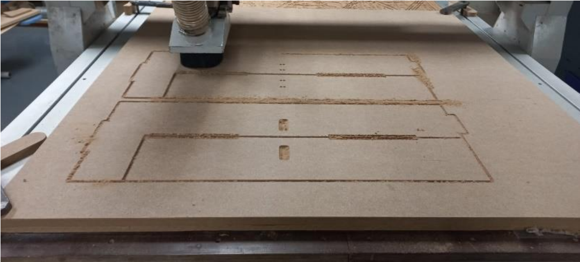
Corte en router CNC para piezas de vitrina de exhibición.
