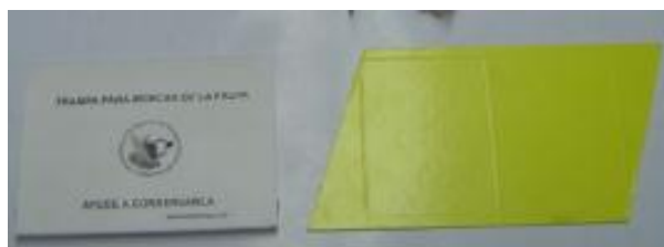
Figura 4. Prisma de cartón encerado y laminilla con “stickem”.
