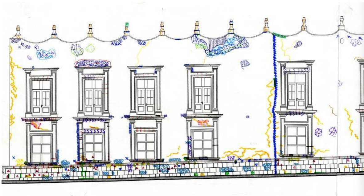
Imagen 15. Registro manual de falta de junta en cantera de la puerta principal del Museo de Arte de la S.H.C.P.
