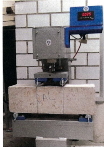
Práctica de resistencia de compresión
