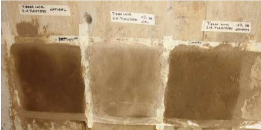
De esta prueba se realizaron 8 muestras de la tierra proveniente del municipio de Chignautla en el estado de Puebla a fin de ver que mezcla mostraba el mejor comportamiento, con esto se pudo establecer las proporciones óptimas de tierra y estabilizantes (cemento y/o cal y/o arena).
