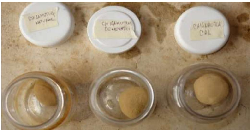
En base a las pruebas anteriores se decidió que la mezcla idónea para fabricar los machihembloques en Chignautla Puebla era del 90% tierra y 10% cemento gris.
