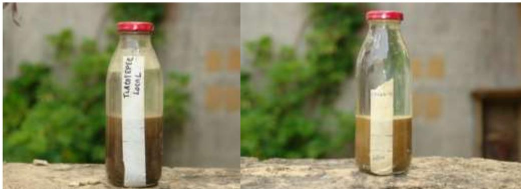
**Prueba de expansión y retracción.** Revoques con un espesor no mayor a 3 milímetros se realizaron a fin de observar el nivel de retracción de la muestra después del secado. En un principio se hicieron tres mezclas de un mismo tipo de tierra:
