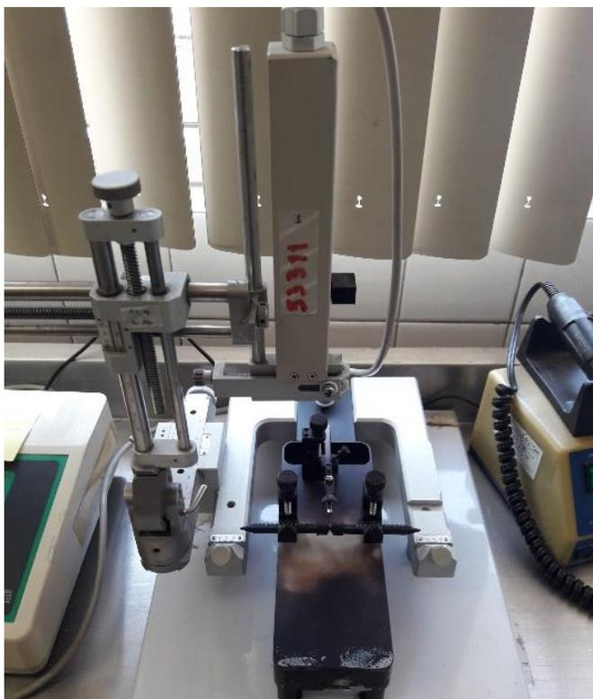
Figura 3. Instrumento estereotáxico Stoelting New Standard™ (No. Catálogo: 51500D).
