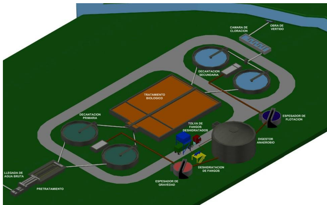
Figura 14. Ejemplo de una Estación Depuradora de Aguas Residuales 58 .
