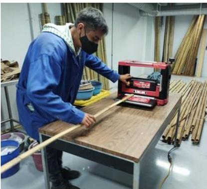
**Imagen 4.** Prueba de desbaste, esterilla de 7mm.
