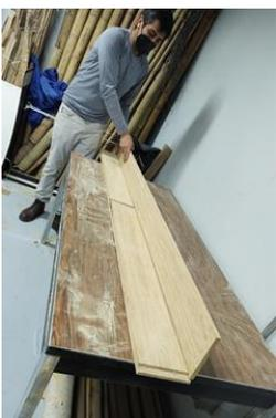
**Imagen 15.** Empalme de tablero de bambú de 12 mm.
