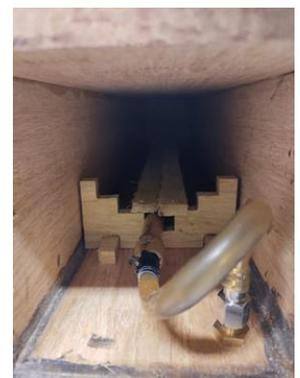
**Imagen 17.** Mangueras para inducción de vapor.
