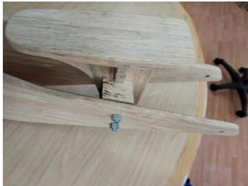
**Imagen 2.** Unión de componentes de bicicleta infantil mediante espárragos.
