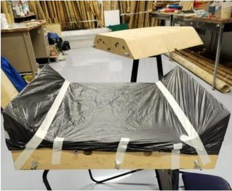
**Imagen 9.** Cubierta de plástico sobre cara de molde inferior.
