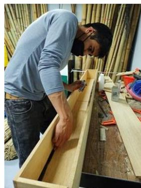
**Imagen 16.** Colocación de silicón de alta temperatura.
