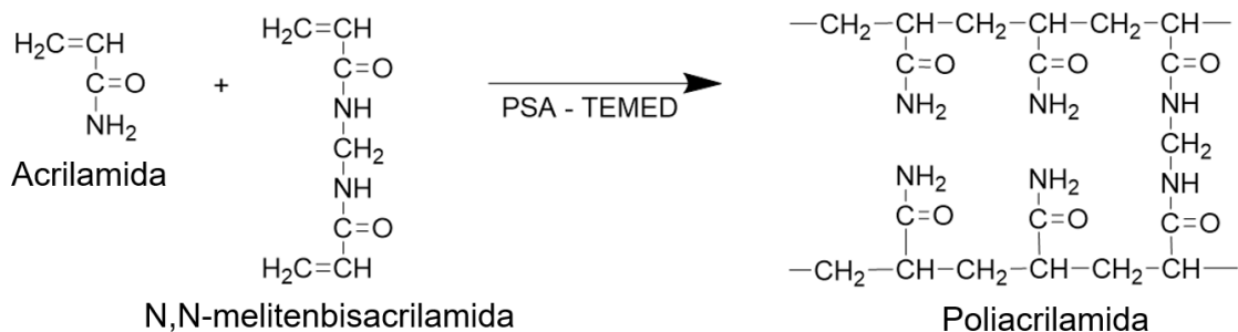
Figura 2. Polimerización de la acrilamida (Basado en Montalvo y Lugo, 2016).
