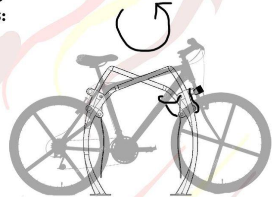
2 amarrando cuadro y 2 ruedas llegando al otro lado de la estructura
