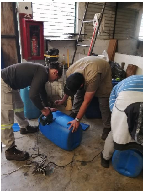
Figura 15. Se realizaron perforaciones en los 6 botes con el fin de juntarlos y formar un refugio en donde pudieran ingresar e incluso dormir. Foto tomada por: (Gómez, 2023)
