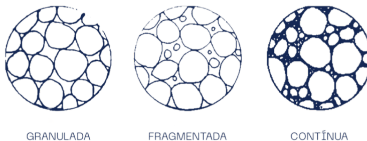
Ilustración 1. La estructura que se busca encontrar para una buena construcción con tierra es la continua. Fuente: Andrea Martínez con base en Houben y Doat (1994).
