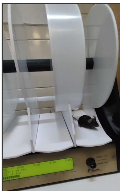
Figura 3 Sujeto en entrenamiento en el rotarod. Se muestra la imagen donde el ratón está teniendo tiempo de reconocimiento en el equipo.
