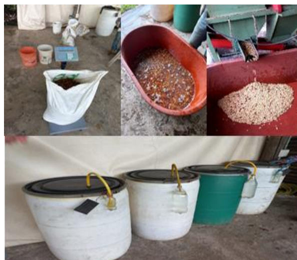
Figura 4. Proceso de beneficiado del café (peso, lavado, despulpe y fermentación).
