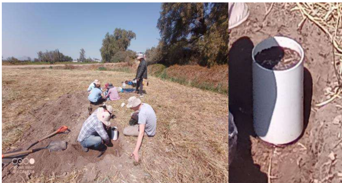
Figura 3. Se muestra parte del proceso para obtener las muestras de suelo inalterado en las columnas de PVC por parte del equipo del Laboratorio de Edafología Ambiental del IG y del proyecto “PARES” de Alemania.
