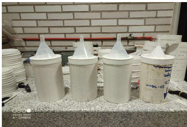
Figura 2. Columnas de PVC para toma de muestras de suelo inalterado con malla para filtro y tapa con embudo para captación de lixiviados.
