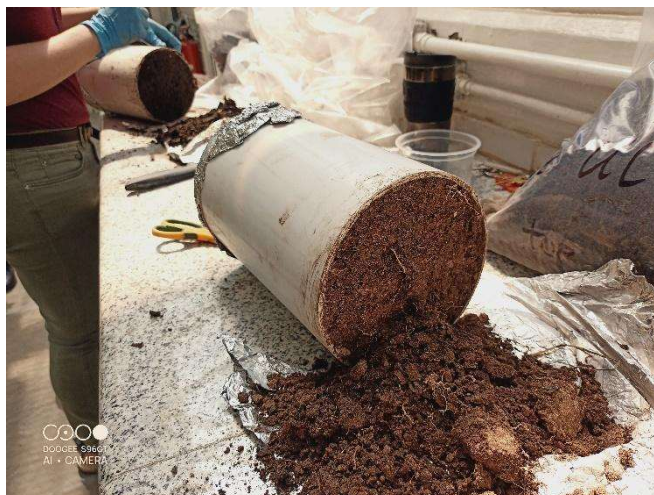
Figura 5. Remoción del exceso de suelo en la base de las columnas para su montaje en las bases ubicadas en el invernadero del IG.
