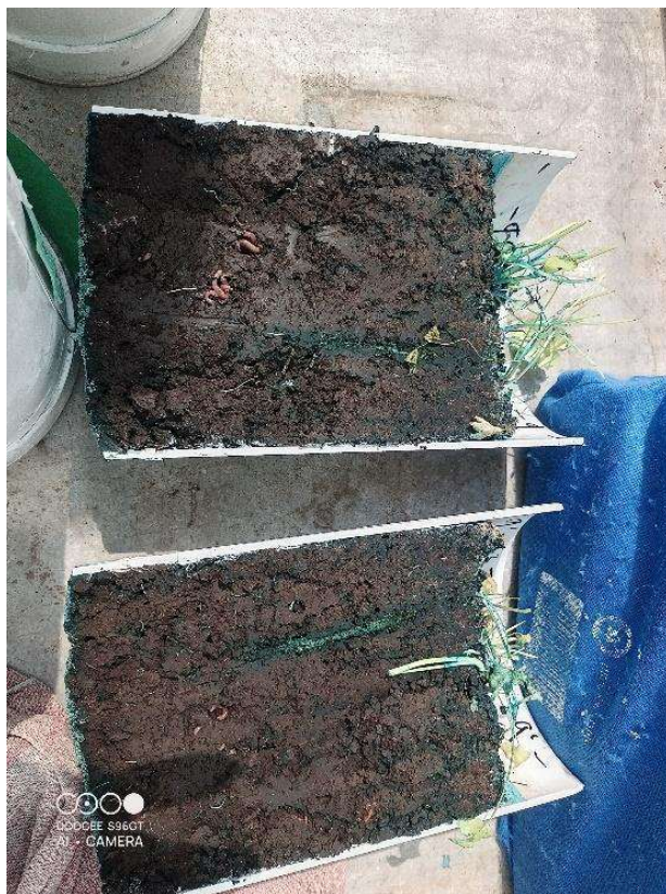
Figura 6. Columna dividida donde se observan los canales preferenciales del agua que fueron coloreados con el marcador aplicado en los riegos.
