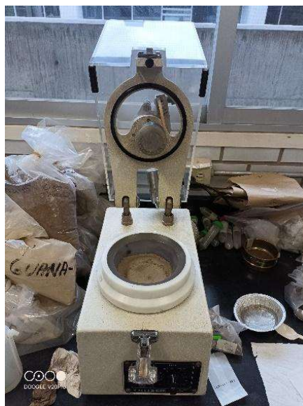
Figura 8. Molino de Ágata usado para moler las muestras de suelo en la determinación de concentración de carbono y nitrógeno total y carbono orgánico.
