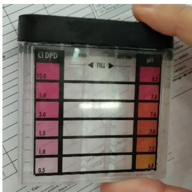
Figura 12: Kitt analizador para Cloro y Ph Mod. 012-003-A-001 el cual se utiliza en el establecimiento antes de iniciar cualquier proceso.
