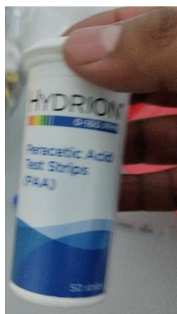
Figura 13: Prueba rápida para ácido peracético utilizada en el rastro.
