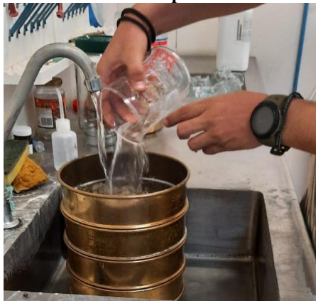
“Colocación de las muestras en tamiz con diferentes medidas para cernirlas”.
