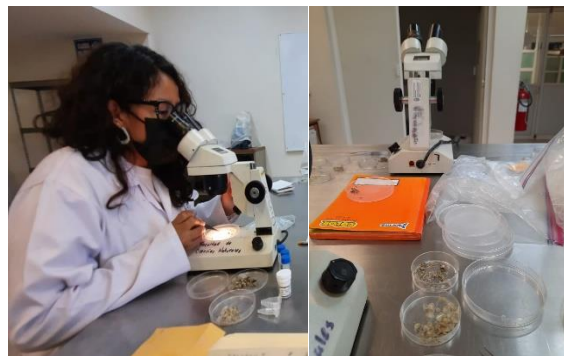
“Separación y análisis de los componentes de las muestras con ayuda de microscopio estereoscópico”.
