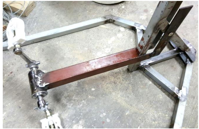
Fabricación y ensamble del poste para pedales
