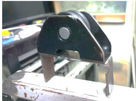
Colocación de poleas para el paso del cable tensor
