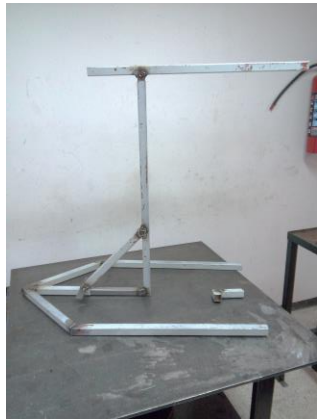
Cortes, soldado y esmerilado del cuerpo de ejercitador
