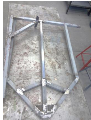
Cortes, soldado y esmerilado del cuerpo de ejercitador
