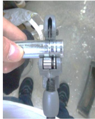
Marca y corte de tubo telescópico para reajustar altura
