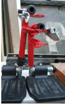
Posa pie izquierdo tamaño original contra posa pie derecho ajustado
