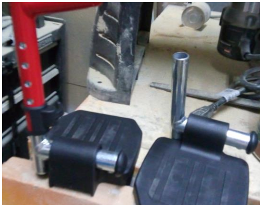
Tubo telescópico cortado contra original
