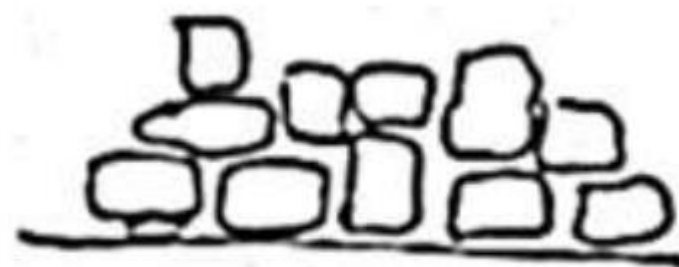
Mampuesto a tizón.
