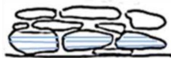
Mampuesto a soga.
