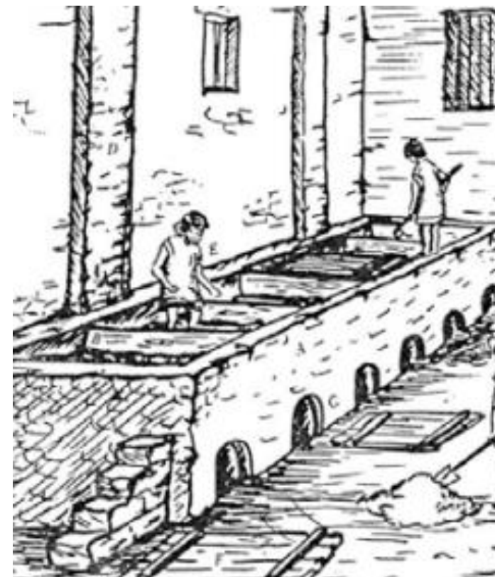
Representación de cajones de buitrón. Fuente: ( https://sisbib.unmsm.edu.pe/bibvirtualdata/libros/2011/vetter_plateros/cap_2.pdf )
