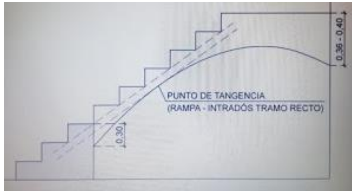
Puntos de arranque de la bóveda tabicada. Fuente Construcción Tradicional Geométrica, 2018, URL
