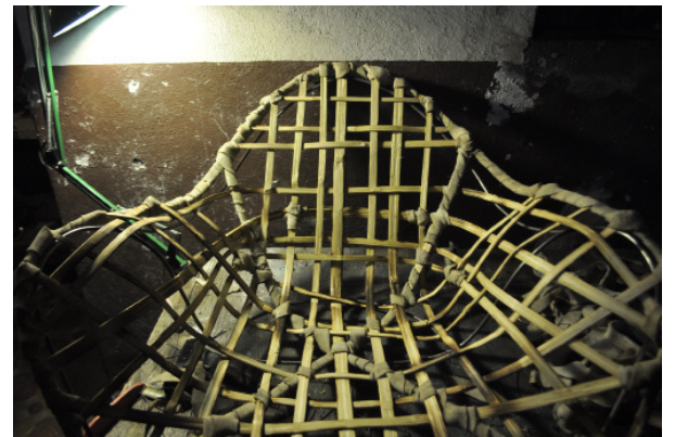
Proceso de termoformado de bambú para mobiliario.
