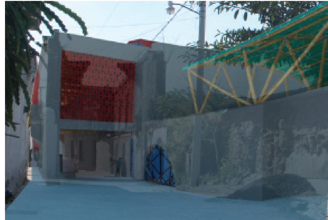
Superposición y montaje de celosía de tabique y estructura tridimensional de bambú en acceso norte.
