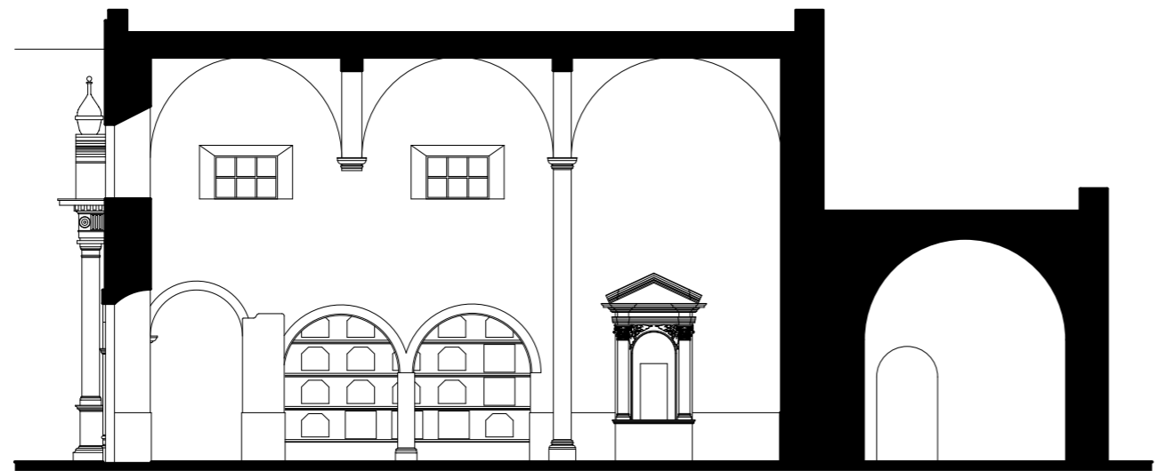
1 Levantamiento estado actual: sección D-D' L.21 Escala 1:150 1.00 3.00 5.00 10.00 20.00
