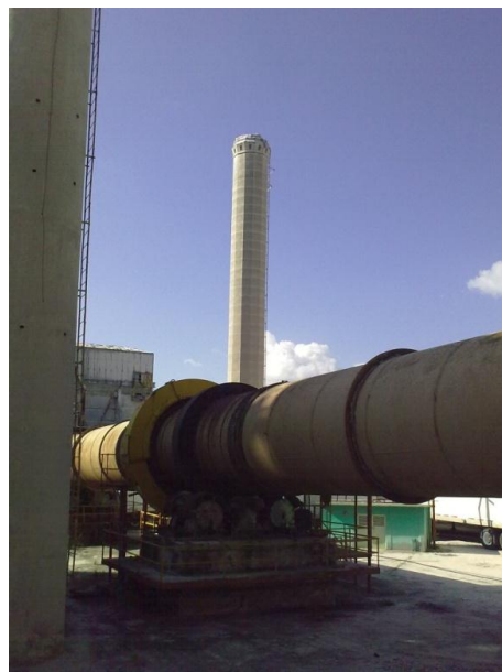
Fig. 2: Antiguo horno de cocción de cemento y chacuaco del año de 1914, considerados en esta investigación como posibles elementos con valores característicos de arqueología industrial.
