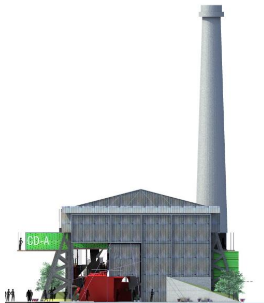
Fig. 91. Fachada principal. Se reutilizan las láminas originales menos dañadas para crear contraste, con los nuevos materiales y texturas.
