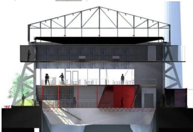
Fig.88. Muestra los dos contenedores estándar que cortan el edificio transversalmente. Están sostenidos por una grúa viajera de 50 toneladas de capacidad de carga, albergaran el espacio de lectura, sumando una carga total de 10 toneladas, como máximo.
