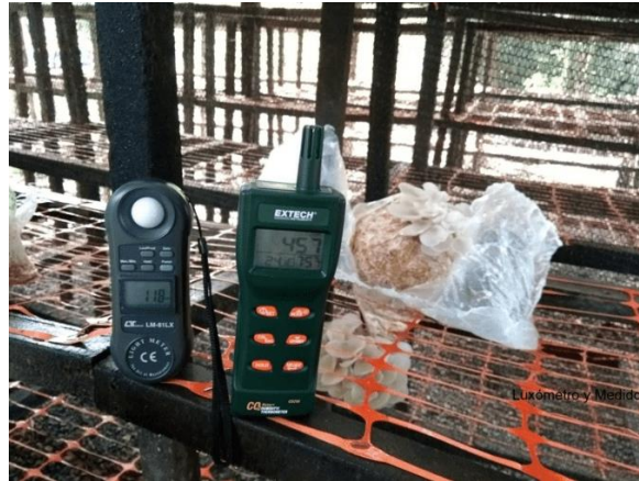
Figura 8. Funcionamiento de luxómetro y medidor de CO 2 . Fuente: Semillero Hongos Comestibles y Medicinales (s/f).
