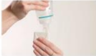
Figura 6. Aplicación del gel en el transductor y en el prisma para la calibración.
