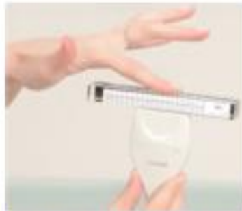
Figura 7. Unión del transductor con el prisma.
