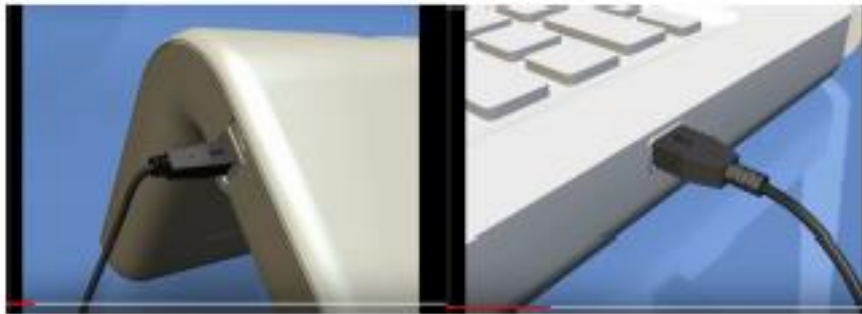
Figura 4. Conexión del cable USB del QUS con la computadora.
