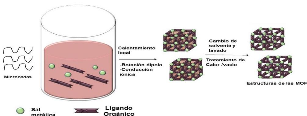
Figura 3. Esquema de la síntesis asistida por microondas (Lee *et al.*, 2013).
