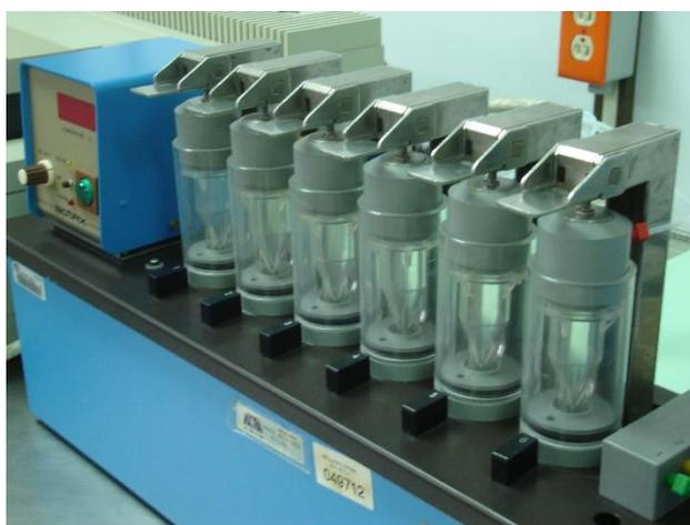
Figura 6. Aparato Figura IV USP Sotax CE-6
