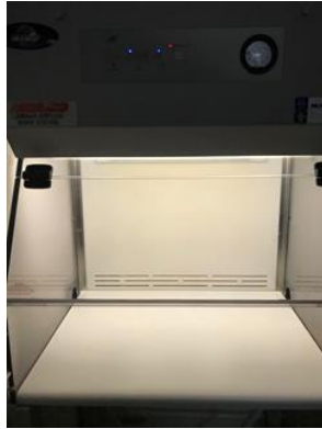
Figura 6. Estación de trabajo de flujo de aire laminar NUAIRE
