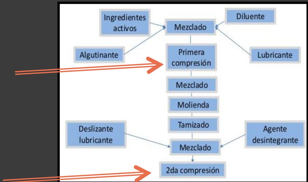
**Figura 16.** Etapas de un proceso de granulación vía seca
