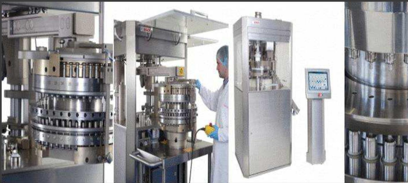
□ Primera fase: Se da lugar cuando se produce el descenso del punzón inferior dentro de la matriz. En dicha cavidad formada, el granulado fluye por gravedad, por ende, la profundidad del punzón inferior en la matriz determinará el volumen de la cámara y consecuentemente el peso de la tableta.
