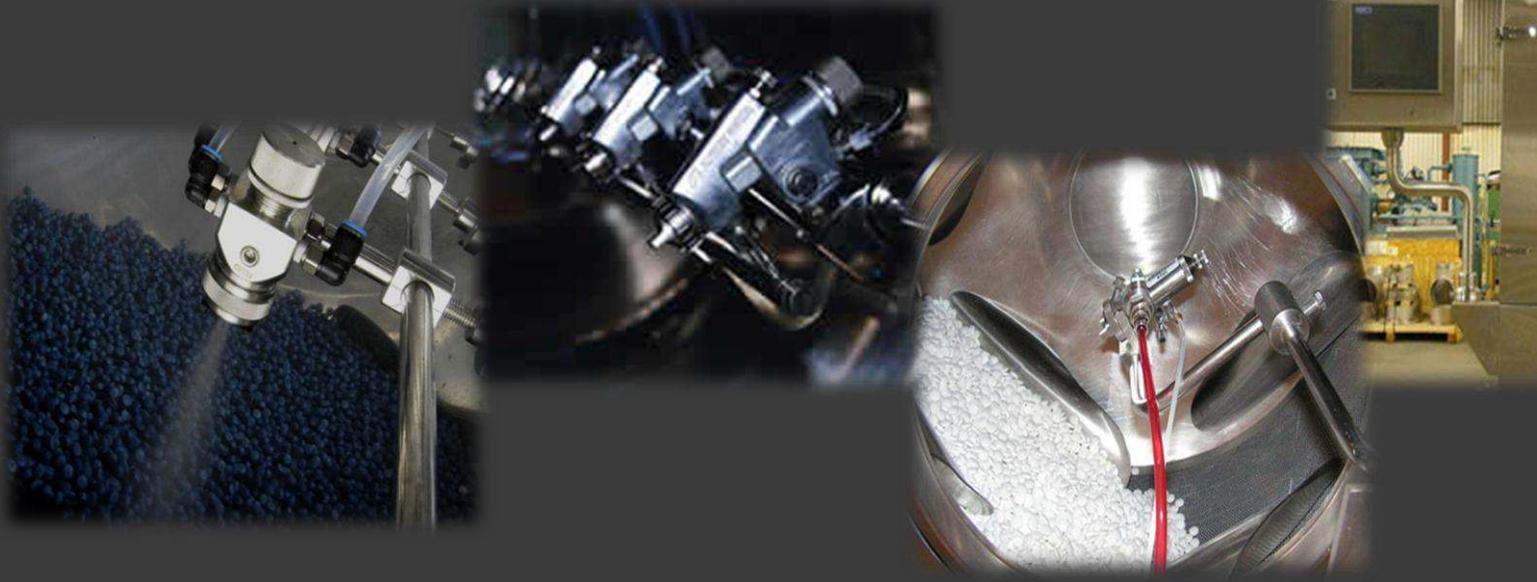
En el medio laboral en algunas Industrias farmacéuticas se lleva a cabo el recubrimiento pelicular con los mismos equipos utilizados para el granulado, incorporando un sistema de atomización y un sistema de secado con aire que garantiza una distribución y extracción homogénea en todo el lote.
