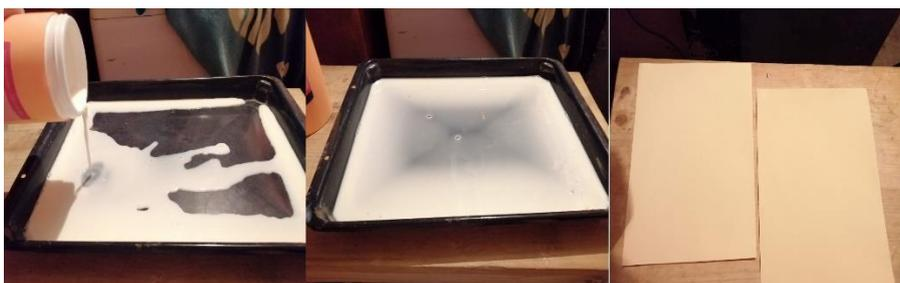
*Ilustración 2. Proceso de obtención de lámina de látex.*
