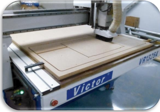
Maquinado en el router del CNC, en MDF de 30 mm
