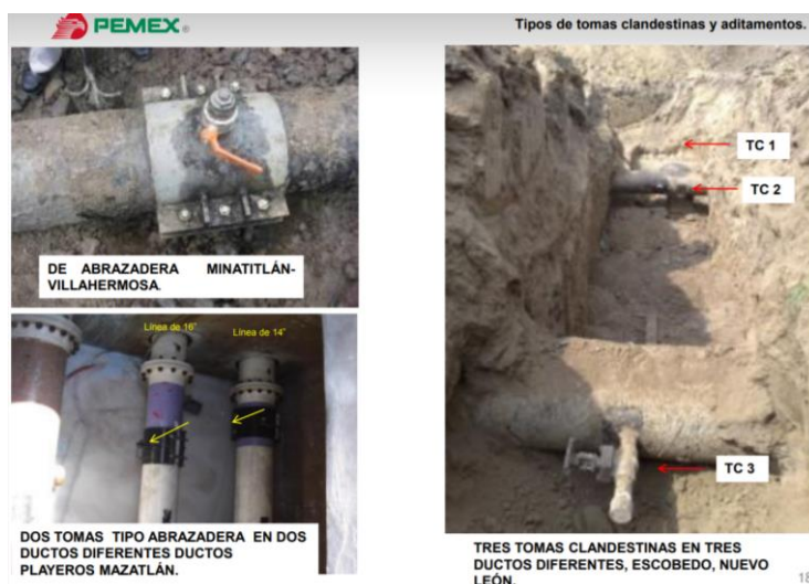
Figura 15. Tipos de tomas clandestinas y aditamentos.
