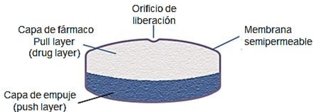
Figura 1: Componentes principales de una bomba osmótica bicompartimental (Piyush, 2012)
