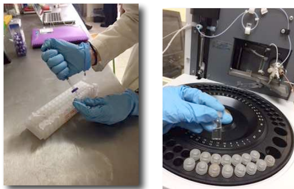
Figura 13. Filtración e inyección a HPLC de muestras de sulfóxido de albendazol y cafeína.
