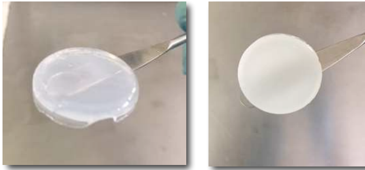
Figura 14. Piezas gelificadas circulares (bottom glass) de hidrogeles blanco y biomaterial.
