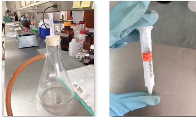
Figura 10. Empaquetamiento a vacío y cartuchos del biomaterial y gel blanco.
