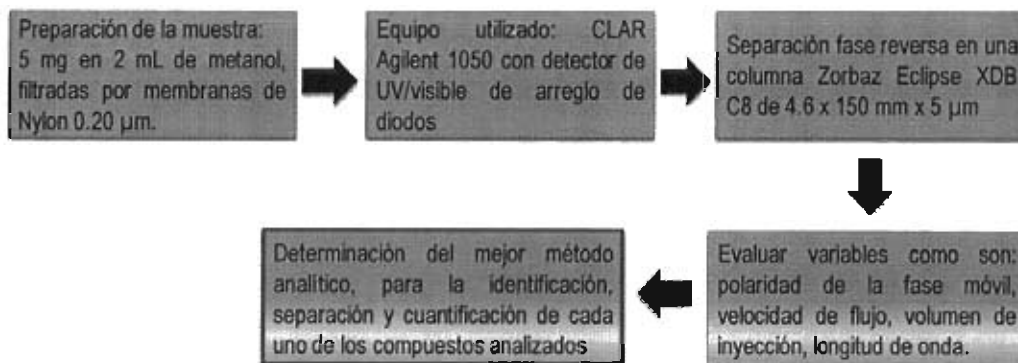
Esquema 27. Diagrama de flujo para la determinación del método por CLAR en fase reversa.
